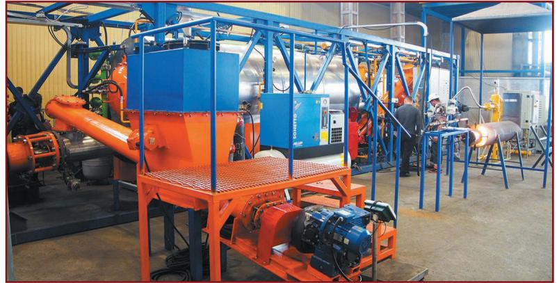
Фото 2. Установка термической деструкции непрерывного действия
