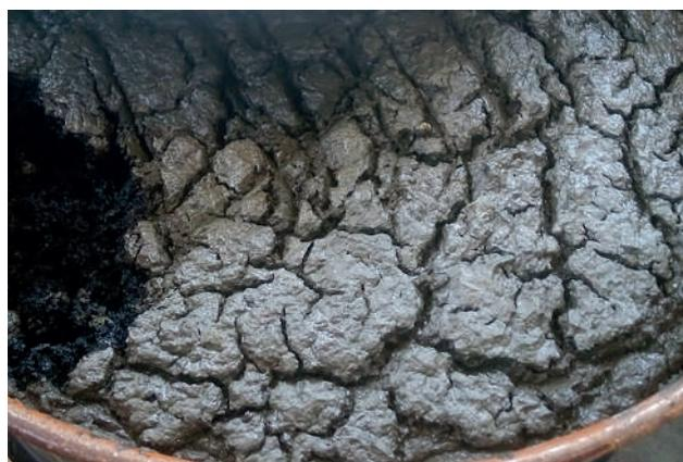
Рис. 1. Ил очистных сооружений.
