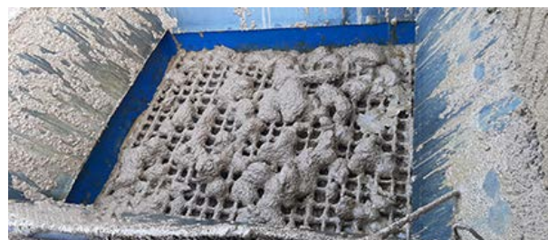
Блок подготовки буровых шламов
