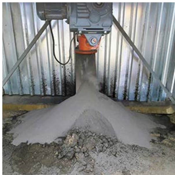
Технический грунт – продукт переработки отходов бурения
